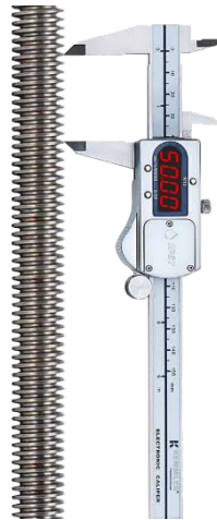
Rys. 4 Pomiar skoku śruby suwmiarką
