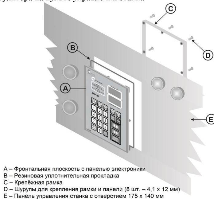
**Рис.2 – установка регулятора как независимого устройства**
